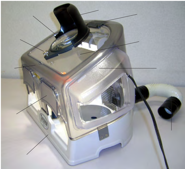
(図1) 本体カプセル レンズ固定ナット 本体ベース スペースドーム フロントパネル スイングガード レンズ フロントパネル用ヒンジ レンズフード 吸塵ホース式
