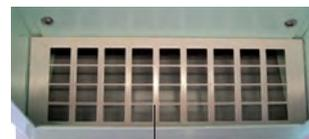
図10 バックフィルター用台（フィルターを受けます）
