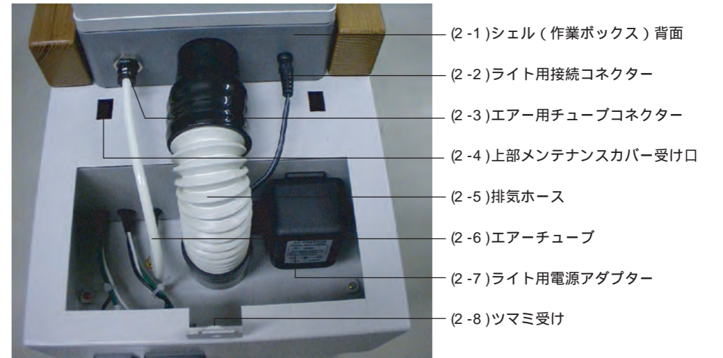
図2：シェルと各部を接続した状態
